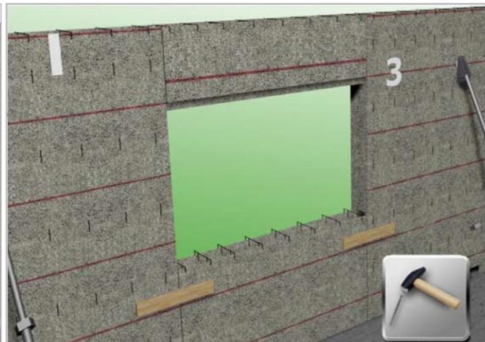
Eingesetztes Sturzelement pro lfm 1x unterstützen
