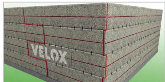
Platten im Verband verlegen; Stöße versetzt
