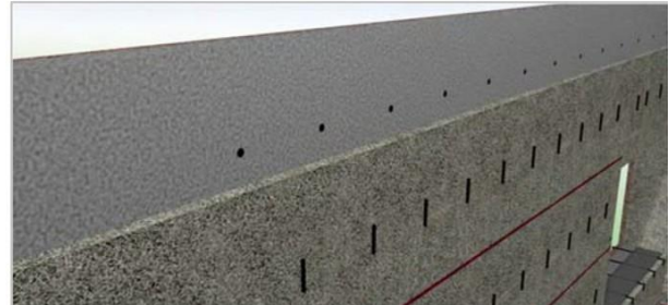
Bohren für Deckenrostbügel: mind. \varnothing 12 mm; 3x pro lfm
