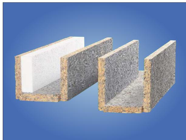
Překlady VELOX se vyrábí ze štěpkocementových desek VELOX WS 35 do rozponu 1000 mm, nad 1000 mm WSD 35. Jsou vhodným doplňkem stavby, nacházejí uplatnění jako překlad nad okenními a dveřními otvory. Díky vložené izolaci, nízké hmotnosti a betonu s výztuží jsou ideálním řešením těchto detailů.
